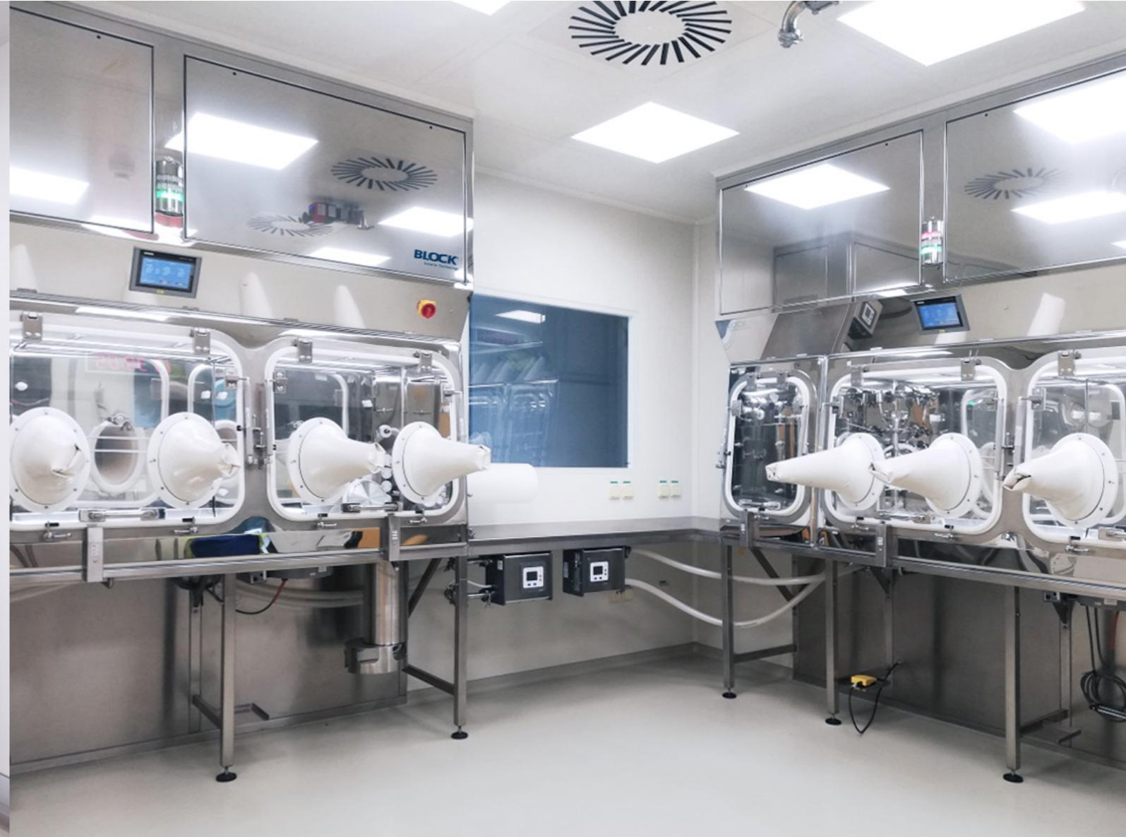
Überdruck-Isolator für Sterilitätstests und Materialschutz, Praha Vaccines a.s. / NOVAVAX CZ a.s., Tschechien
