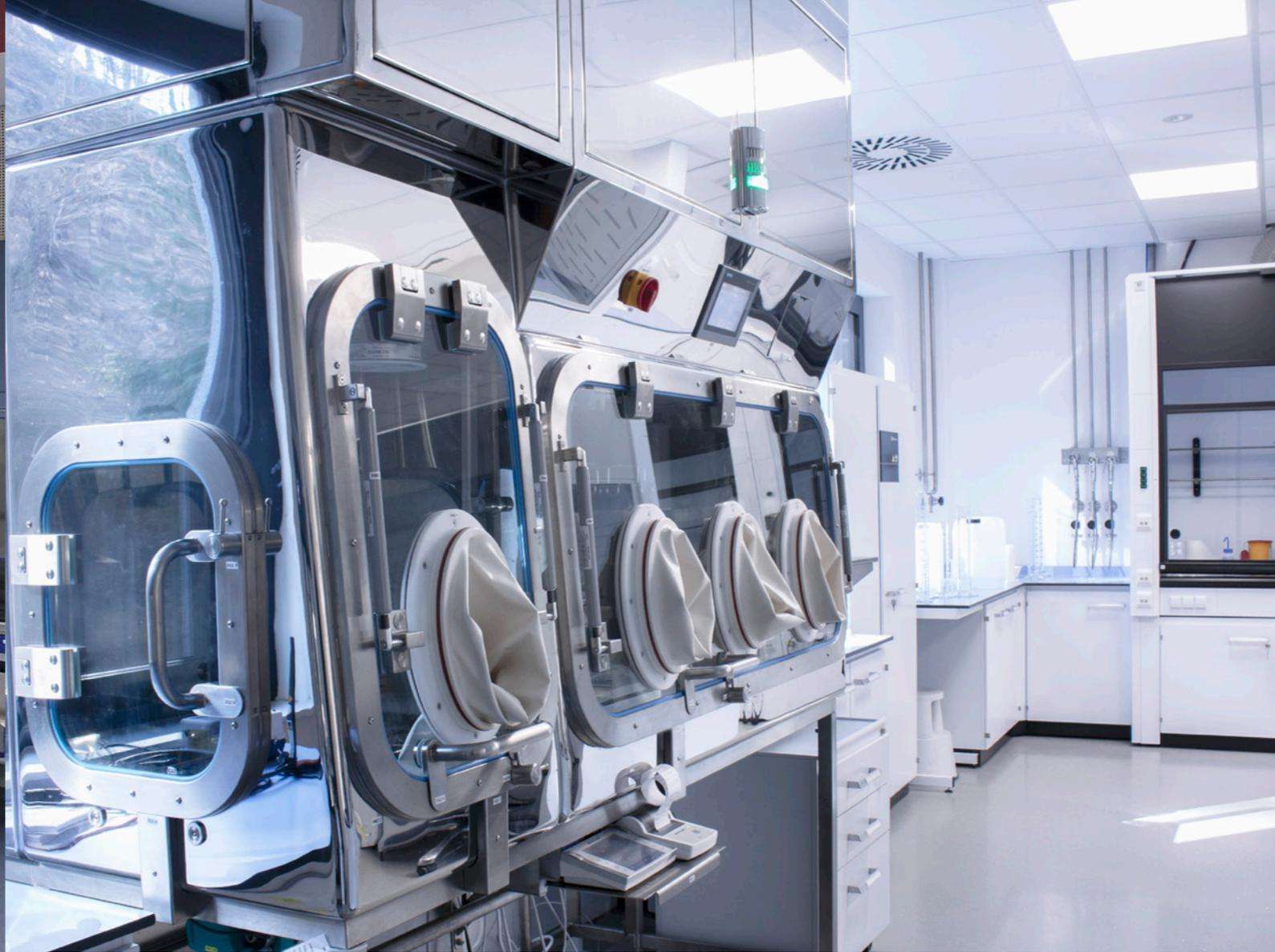
Unterdruck-Isolator für die Verarbeitung von licht- und feuchtigkeitsempfindlichem API-Material, Synthon, s.r.o., Tschechien
