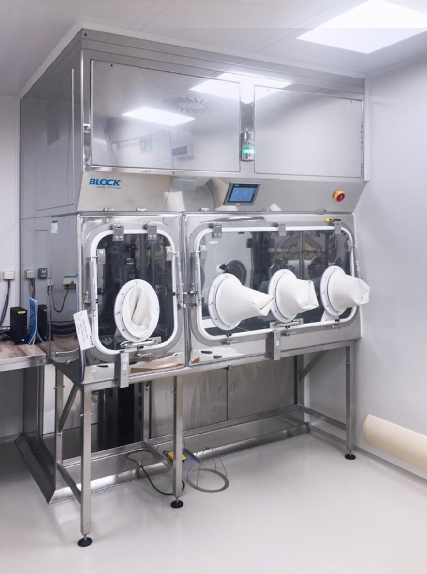
Unterdruck-Isolator für die Handhabung von infektiösem Material, Praha Vaccines a.s. / NOVAVAX CZ a.s., Tschechien
