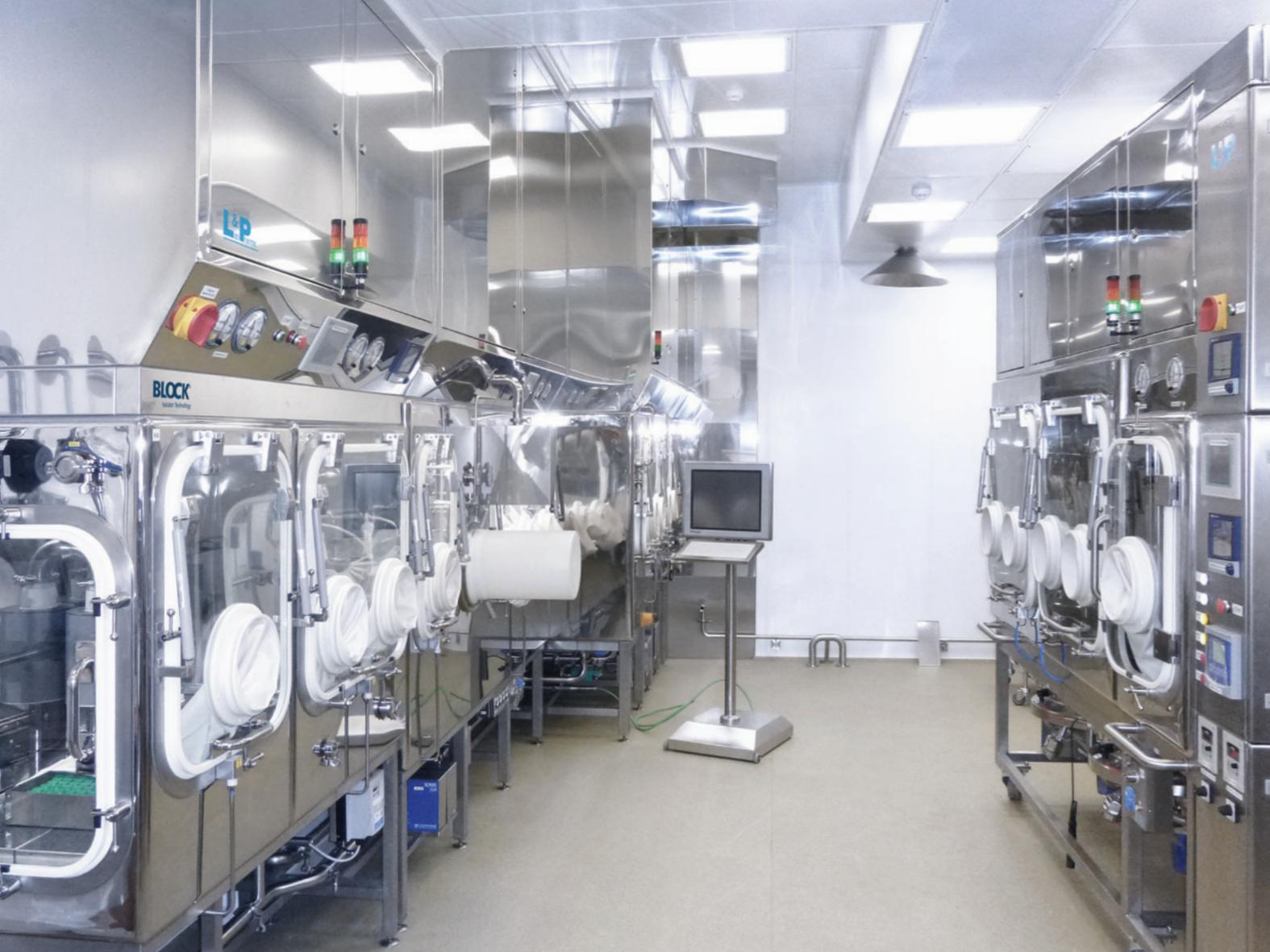
Isolator zum Abfüllen von Zytostatika in Flaschen, Einsetzen und Entnehmen von Flaschen in/aus Lyophilisierungsanlagen und zum Verschließen von Flaschen, RUE "BELMEDPREPARATY", Belarus
